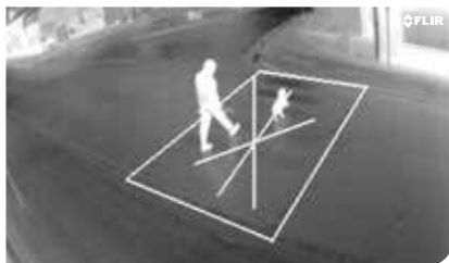
Erkennung von Fußgängern an Überwegen
