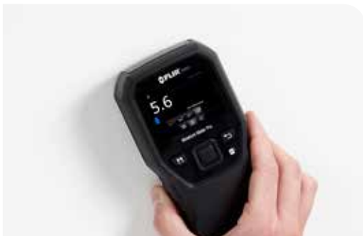
Verifique la humedad con mediciones sin clavija.
