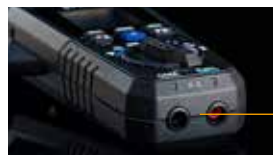
Entrada de cables de prueba
