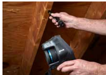
Mit dem MR40 können Sie überprüfen, ob es sich bei einer kalten Stelle in einem Wärmebild um Feuchtigkeit handelt
