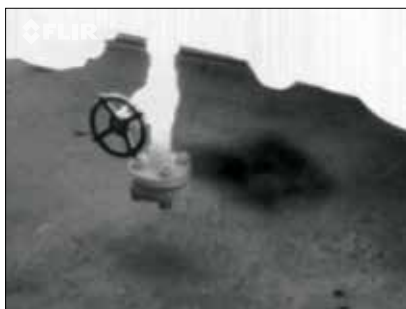
Fuite de méthane sur un site de production de gaz naturel
