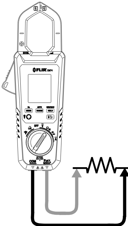
Abb. 5.5 Widerstands- und Durchgangsmessungen
