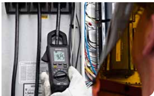
True RMS（真の実効値）AC電流は最大600A
