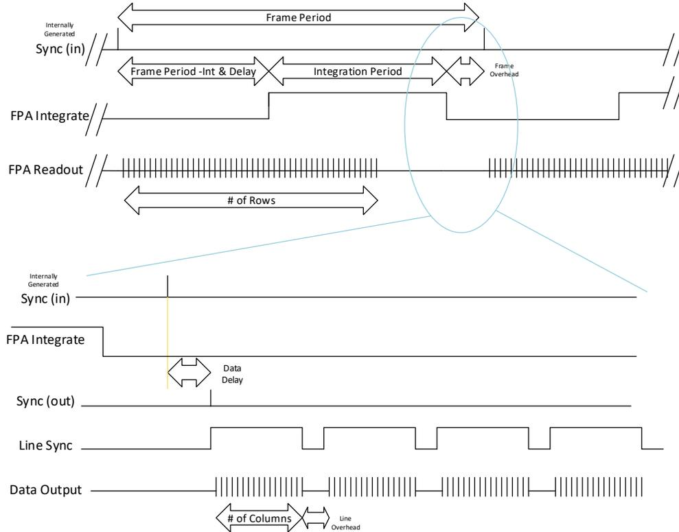
**Figure 14 Free Run, Readout Priority**
